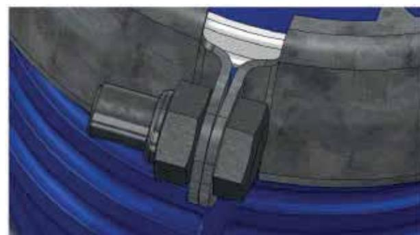
Fig. 32 Dettaglio della vite serrata con orecchie forate portate in accosto.
